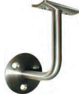
Handlaufträger, Edelstahl Korn 240 matt, für Handlauf Ø42,4mm, Rohraufnahme 65*22*3mm (verschraubt), Platte Ø64/4mm, Wandabstand 75mm, Löcher gesenkt, Stift Ø12mm                         | Stk.    | 13,10 €     | 15,72 €     |
